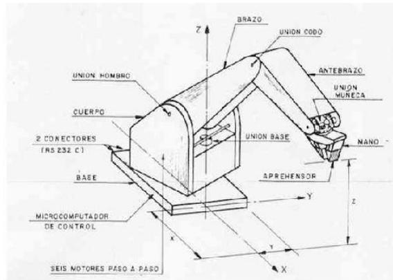
*Figura 1.* Diseño exterior del Brazo Mecánico. Elaboración Propia
