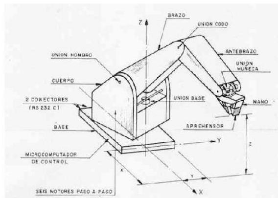
*Figura 2.* Diseño exterior del Brazo Mecánico. Organización Internacional del Trabajo.
